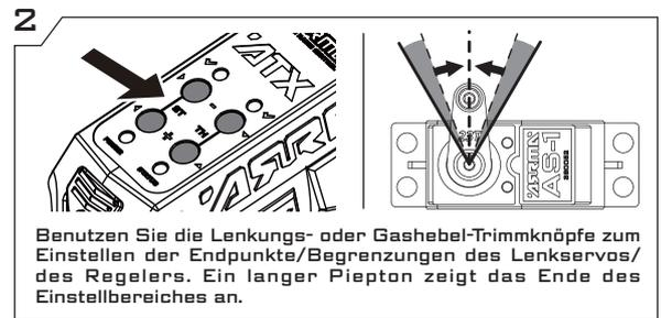
Benutzen Sie die Lenkungs- oder Gashebel-Trimknöpfe zum Einstellen der Endpunkte/Begrenzungen des Lenkservos/ des Reglers. Ein langer Piepton zeigt das Ende des Einstellbereiches an.
